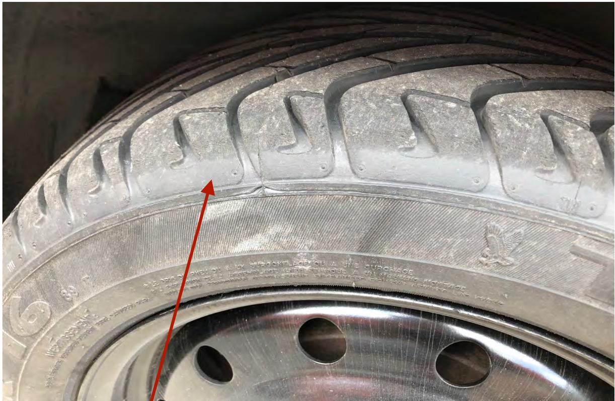
Légende : Marque d'usure sur le pneu Techno (remoulé)
