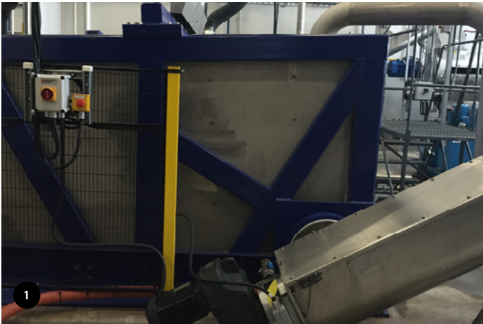
1. Photographie de côté de la trémie de réception et du convoyeur d'alimentation. Source: Chamard (sans date), photographie prise à l'usine de Saint-Hyacinthe. 2. Photographie du broyeur à marteaux. Source: Mabarex (novembre 2014), Traitement des eaux et des résidus organiques, présenté par Denis Provencher, ing., vice-président.
