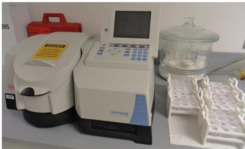
FIGURE 4 Spectrophotomètre UV-Vis
