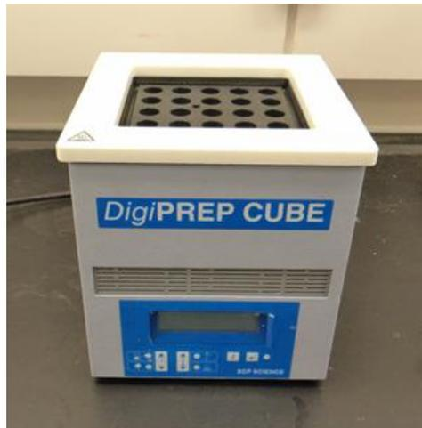
FIGURE 3 Bloc de digestion
