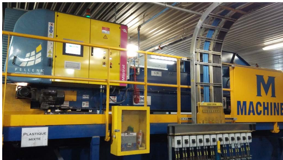
Figure 6-5 Photo de l'un des deux séparateurs optiques au centre de tri de la Ville de Québec
