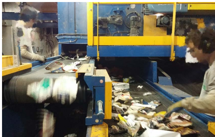
Figure 6-2 Photographie de la sortie du second tri optique au centre de tri de la Ville de Québec
