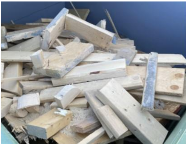
Bois Q1 contaminé par béton
