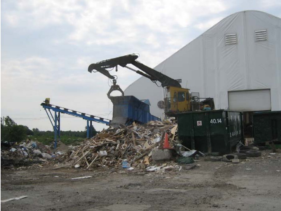
Figure 2 : Chargement des débris de CRD sur la table d'alimentation (Centre de tri « transformation des matières recyclables » à Saint-Sébastien)
