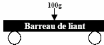
Figure I.7: Principe de l'essai de BBR [12]
