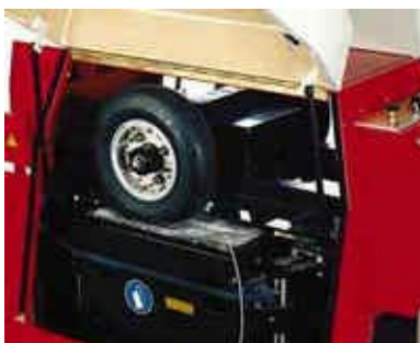
Figure I.17: Vue d'une plaque d'enrobé soumise à l'essai d'orniérage
