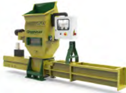
Densificateur par vis d'entraînement (modèle GreenMax Apolo C100) 1
