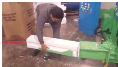
c) Séparation manuelle des briques de PS
