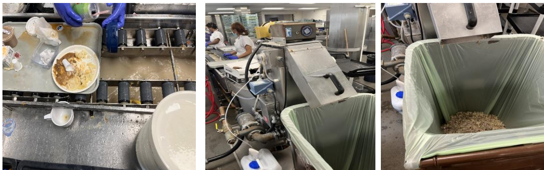
Figure 4 : Installation de tri des matières organiques (rivière et tritrateur)
