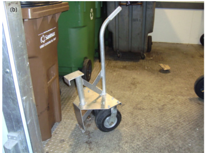
Figure 2 : (a) Les bacs sont entreposés dans une chambre froide. (b) Pour en faciliter la manutention, on utilise un levier muni de roues. (Photos : Hôpital Jean-Talon)
