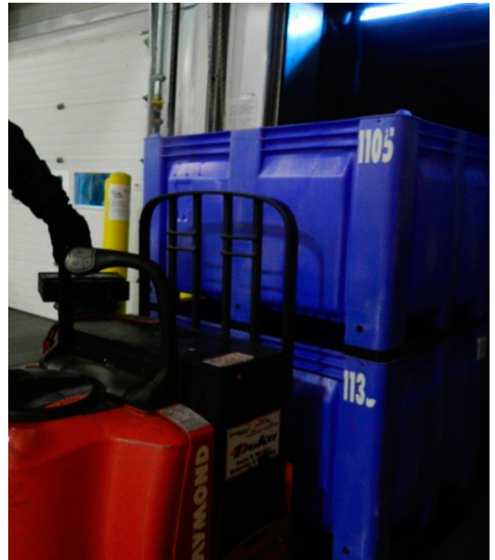
Figure 3 : Le déplacement des bacs se fait à l'aide d'un monte-charge, car ils peuvent peser jusqu'à 680 kg chacun. (Photo : Canadawide)
