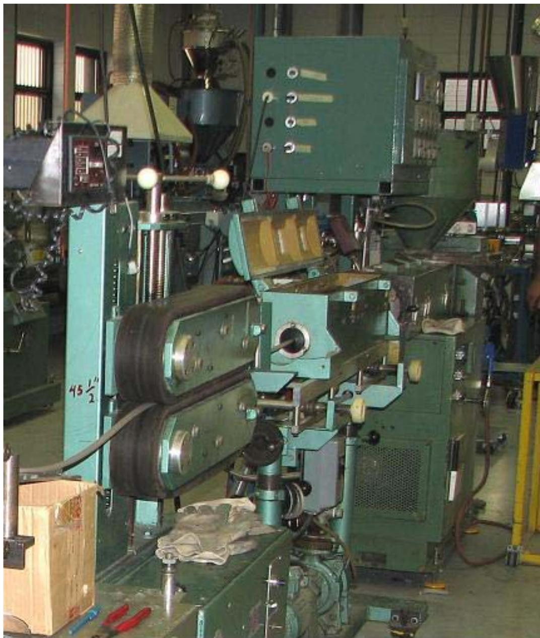
**Figure 2**    **Système de production des profilés par extrusion**
