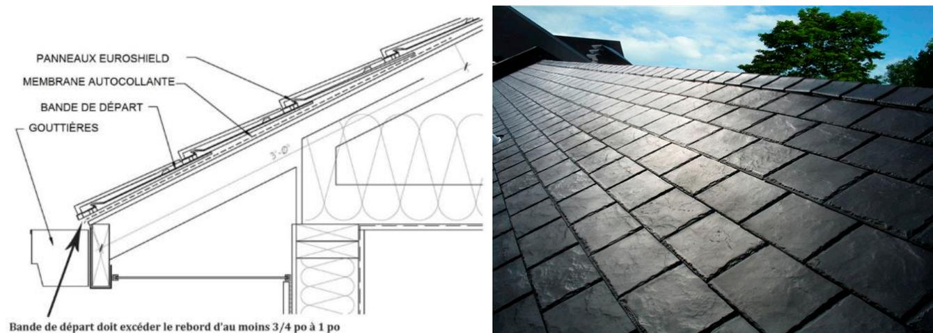
**Figure 5: Structure et installation de bardeaux en composite**
