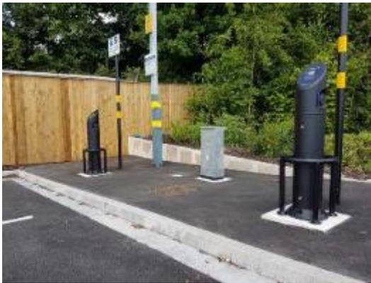
**Figure 22** Ceinture de protection en métal pour bornes de recharge (source : bollardstreet.com)
