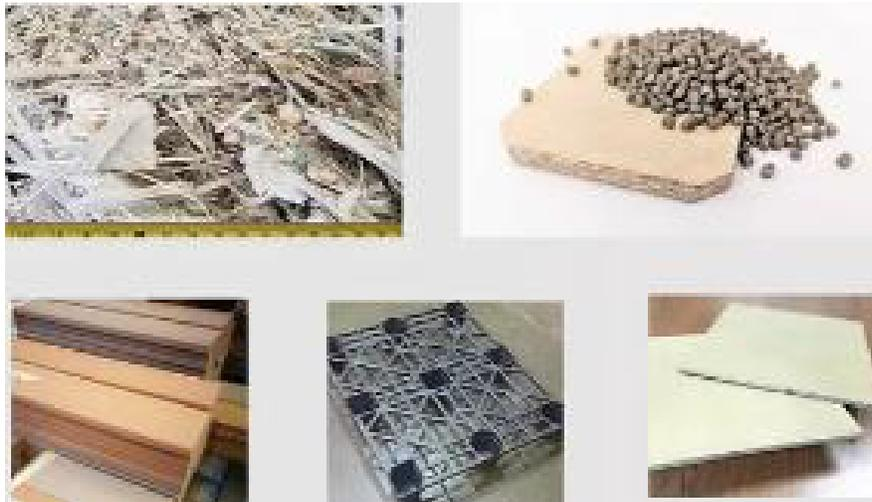
**Figure 5 Transformation de la fibre de verre des pales éoliennes en différents matériaux (source : [www.globalfiberglassinc.com/](http://www.globalfiberglassinc.com/))**
