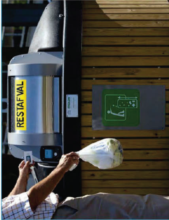
Conteneur d'apport volontaire avec contrôle d'accès (OptiWaste)
