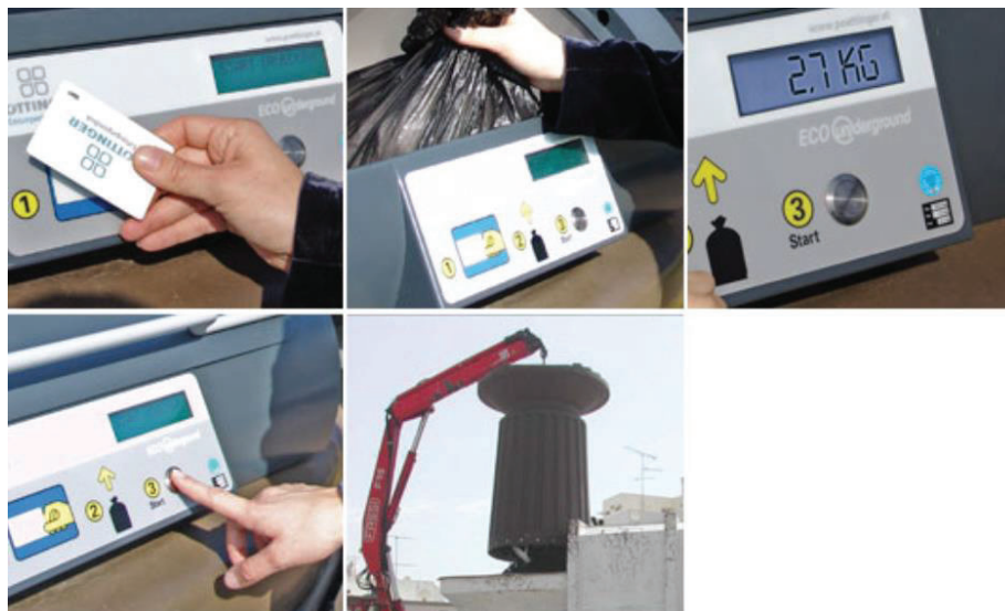
Figure 18: Système de contrôle d'accès par carte avec affichage de la pesée des matières [7]
