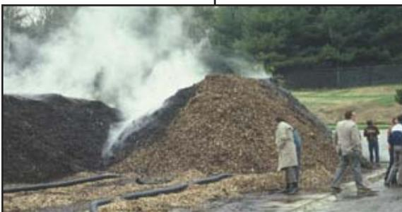
Piles statiques sous aération forcée
