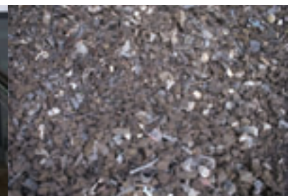
Le résidu de broyage automobile (RBA), une fois les métaux extraits à la sortie du déchiqueteur
