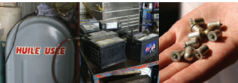
Lors de la dépollution d'un véhicule hors d'usage, les huiles et les fluides sont récupérés.
