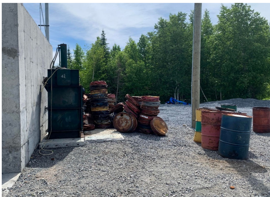
Figure 25 : Presse hydraulique pour barils située à l’écocentre du village cri de Mistissini
