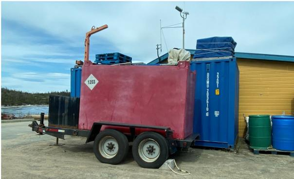
**Figure 8 : Réservoir mobile de la Coop Chevery, pour le transport des produits pétroliers de Harrington Harbour vers Chevery**
