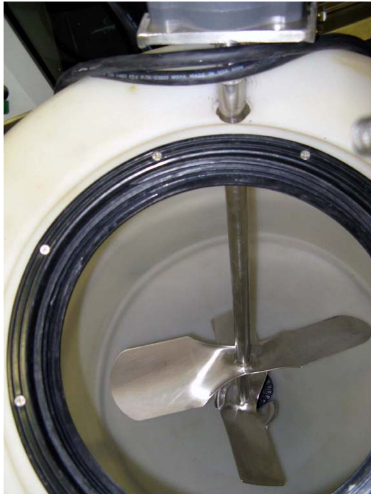
■ Figure 5 – Pales de l'agitateur à l'intérieur du réservoir
