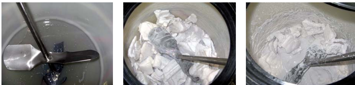
■ Figure 9 – Évolution de la dissolution du polystyrène
